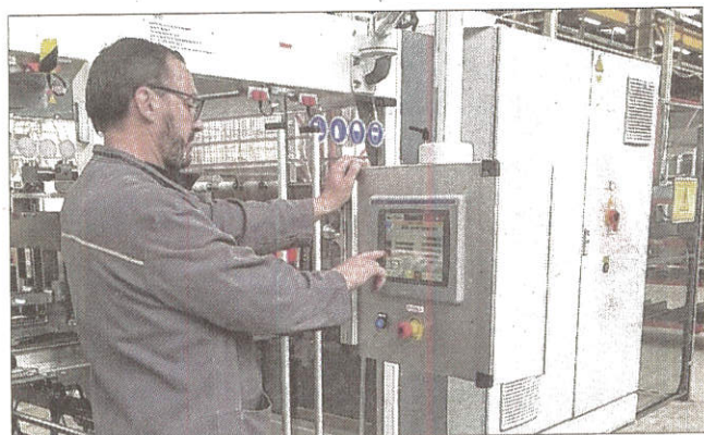
■ Philippe Theuil est technicien régleur, le plus haut poste. Sur cette image, il prépare le programme pour tester cette formeuse de caisses haute cadence (65 cartons par minute) sur un nouveau packaging. Photo DR
