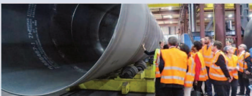
Des segments de 30 mètres de long seront assemblés pour former des mâts d'éoliennes pouvant atteindre 120 mètres de haut. Ces derniers seront ensuite prêts à être livrés.
